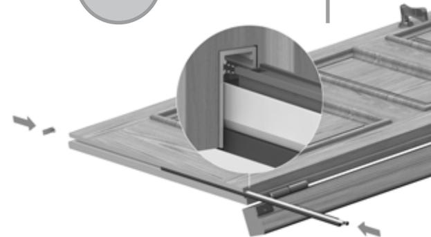
**6** НАВЕСИТЬ ДВЕРЬ НА ПЕТЛИ, УСТАНОВИТЬ ОТВЕТНУЮ ПЛАНКУ В КОРОБКУ И ОТРЕГУЛИРОВАТЬ ПРИЖИМ ПОРОГА К ПОЛУ
